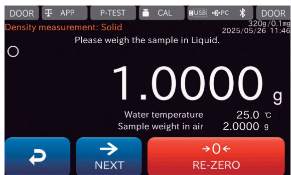
Dichtemessung einer festen Probe
