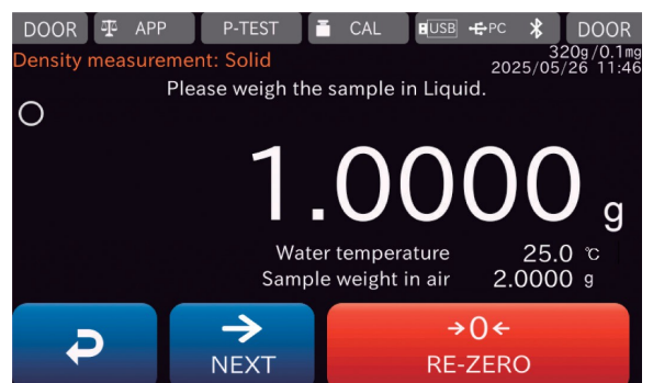
Dichtemessung einer festen Probe
