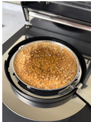
Réglage de la température de séchage de dessiccation plus élevée qu'il ne faut
